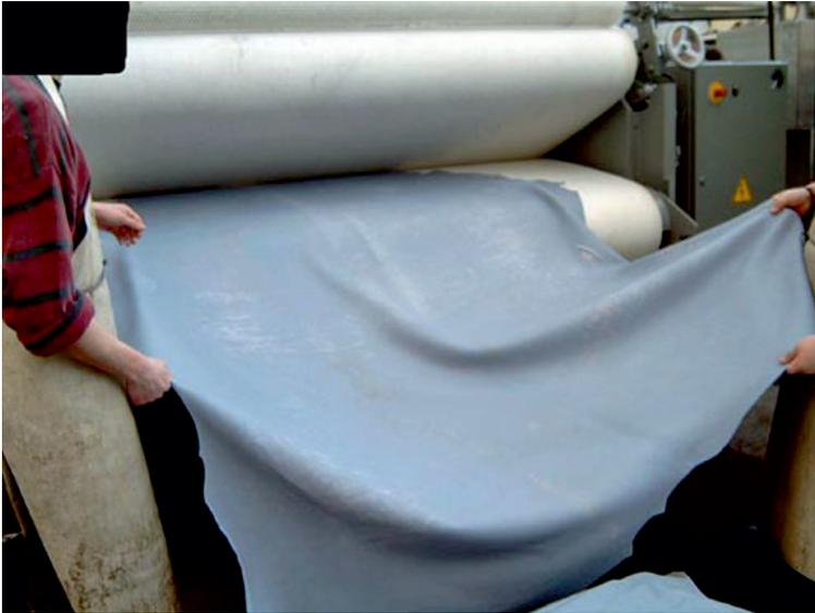
Abb. 1. Arbeiten mit „Wet blue“ an einer Abwelkmaschine. Quelle: Lederpedia.de [22]. Abdruck mit freundlicher Genehmigung der Lederpedia-Redaktion.
