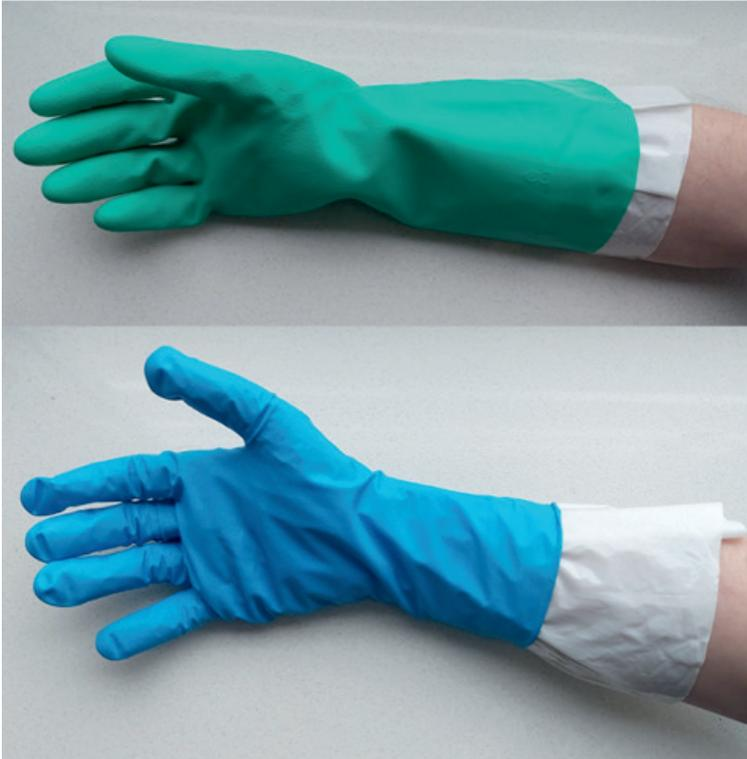
Abb. 1. LLDPE-Laminatfilm-Handschuh als Unterzieh-Handschuh unter einem Nitril-Mehrweghandschuh und unter einem dickwandigen Nitril-Einmalhandschuh.
