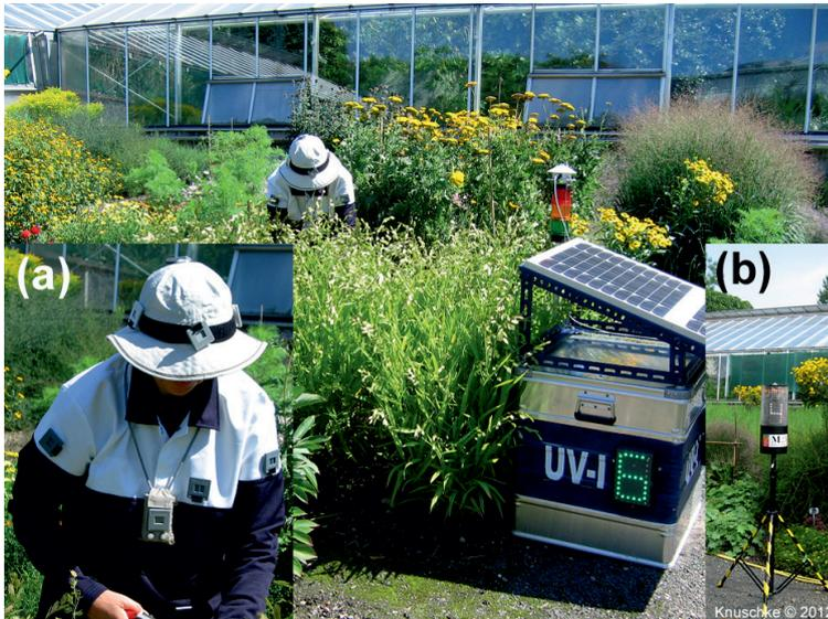
Abb. 2. Maßnahmen zur Reduktion der solaren UV-Exposition an Außenarbeitsplätzen: (a) personenbezogene Maßnahmen durch textilen UV-Schutz von Haut und Augen, (b) technisch-organisatorische Maßnahme durch ständige Information der Mitarbeiter über den aktuellen UV-Index mittels „mUVI“ (mobiles UV-Index-Messgerät der BAuA: autonom, batteriegestützt „mUVI 1.0“ bzw. schlank, netzgestützt „mUVI 2.0“ [17]).
